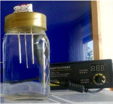
Mit jedem Kolloidgeät, also auch mit 'Elektrolyse 4All' können durch verschiedenste (Halb-)Metallelektroden auch entsprechende Metall-Kolloide hergestellt werden.
