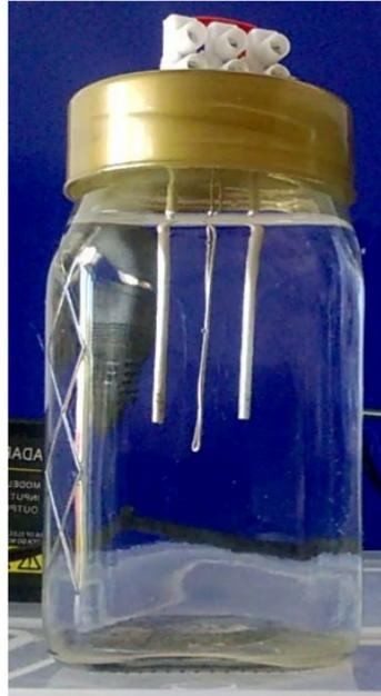
Abbildung: Seitlich 2 Silberelektroden als Anoden, 1 V2A-Elektrode dazwischen.
