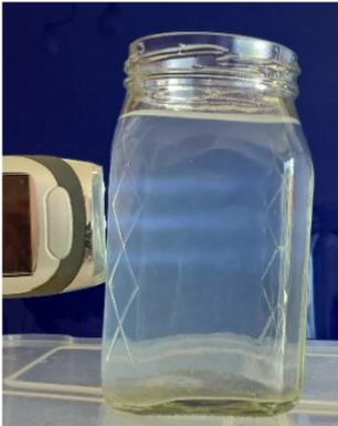
Diese Konzentration von 3-5 ppm ist meist schon erreicht, wenn ein gebündelter Lichtstrahl im Silberwasser scharf konturiert sichtbar wird. ([Tyndall-Effekt](#))
