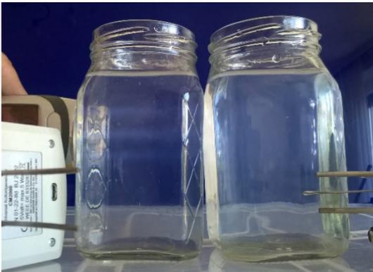
Schwacher Tyndall-Effekt nach 130 Sekunden Elektrolysedauer.
