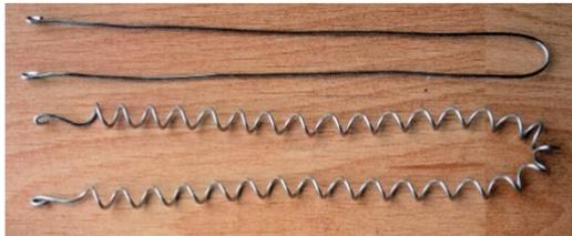
An einer geraden Kathode steigt (je nach Mineralien) H<sub>2</sub>-Gas sehr schnell und direkt an die Wasseroberfläche und entschwindet in die Luft.
