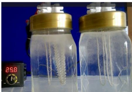
Für den Test wurden 12 Tropfen Sole in 350 ml (Bodensee)Leitungswasser gegeben und die Elektrolyse mit 24 Volt durchgeführt.
