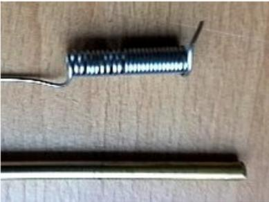
Jener Drahtteil, der im Hohlstab war, wird mit einem Finger oder Zange herausgezogen und Knicke mit der Spitzzange gerade gemacht.
