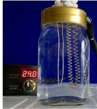
Abbildung: ‚Elektrolyse 4 All‘-Gerät mit Spiralkathode.
